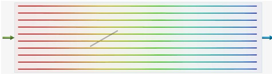
Vazão passando por uma placa fina simulada com a versão 2024,1. As linhas de corrente são desviadas devido à placa fina.
