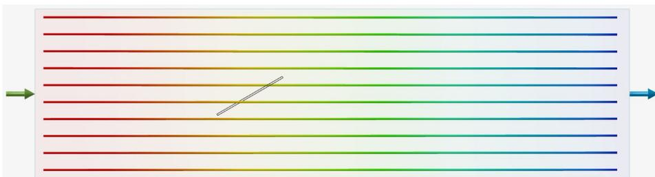
バージョン2024.1でシミュレーションした薄いプレートを通過する流れ。プレートが薄いため、ストリームラインがたわんでいます。
